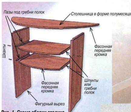
Рис. 1. Схема сборки столика.
