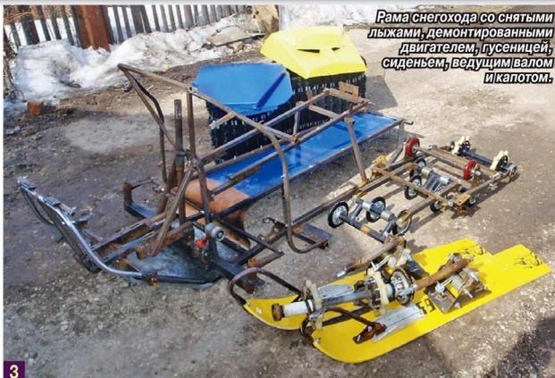
Рамa снегохода со снятыми лыжами, демонтированными двигателем, гусеницей, сиденьем, ведущим валом и капотом.
