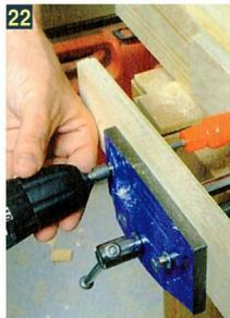
21 Для крепления механизма тисков может потребоваться установка дополнительного бруска с внутренней стороны столешницы.
