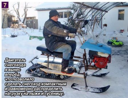
Двигатель снегохода явяьнес вперёд, что позволило сделать снегоход компактным и равномерно распределить нагрузку на лыжи и гусеницу.
