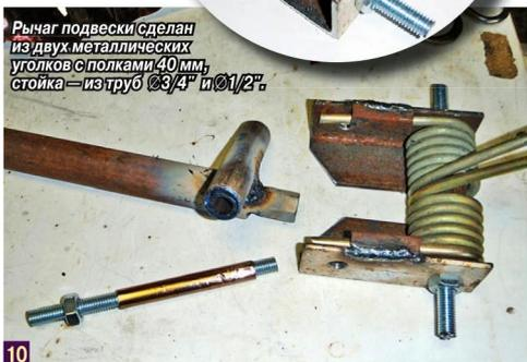
**Рычаг подвески сделан из двух металлических уголков с полками 40 мм, стойка — из труб 3/4" и 1/2".**
