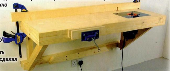
Компактный верстачок, оснащённый столярными тисками и вертикально установленной фрезерной машинкой с направляющей линейкой, — прекрасный помощник домашнего мастера.
