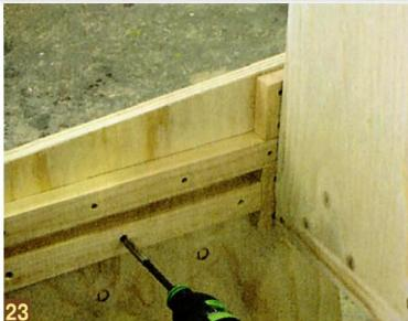
**21** Для установки подспинки нам потребуется закрепить на каждой боковине по два дополнительных бруска, которые будут задавать наклон спинки и сиденья. Верхний дополнительный брусок заливаем ровень с боковиной. Снизу на подспинку крепим опорный продольный брусок.
