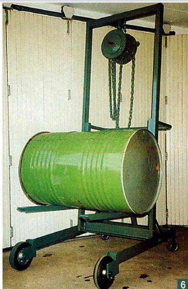
**Рис. 3. Узел механизма подъёма.**
