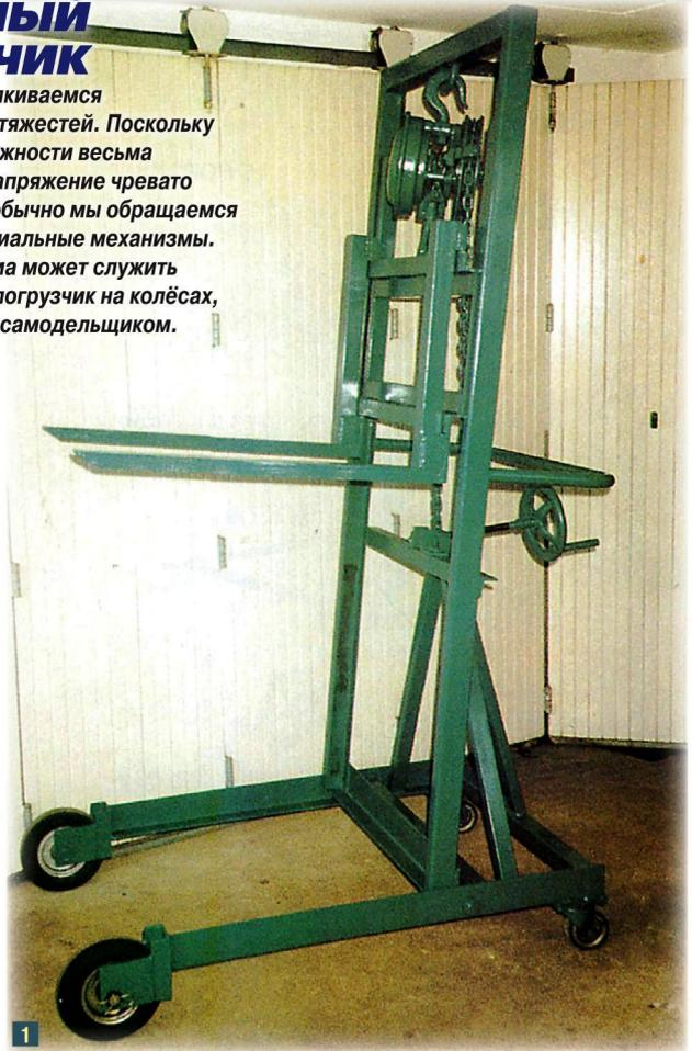
соответствующим лонжеронам, а третья — к крайней траверсе **12** основания. Сверху к стойке приварен уголок **14**, на котором установлен шарнир с гайкой **15** для винта **16** регулирования наклона рамы. Стойку центрируют так, чтобы ось гайки совпала с осью подшипника на перекладине рамы, находящейся в вертикальном положении. Выполнение этого условия позволит легко собрать пречную работу.
