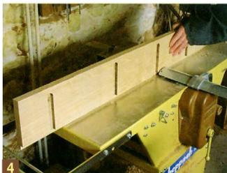
4 Прострогайте задние кромки, чтобы удалить задиры.
