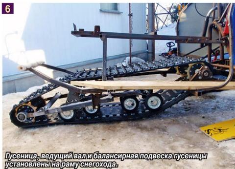
Гусеница, ведущий вал и балансирующая подвеска гусеницы установлены на раму снегохода.
