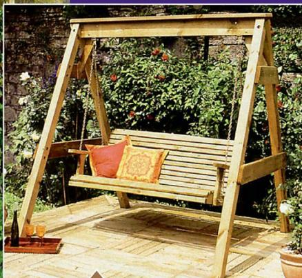
Деревянный диван, подвешенный на цепях, является привлекательным местом отдыха для взрослых и детей. Для изготовления опорной стойки использован брус сечением 100х100 мм и доски 50х150 мм.
