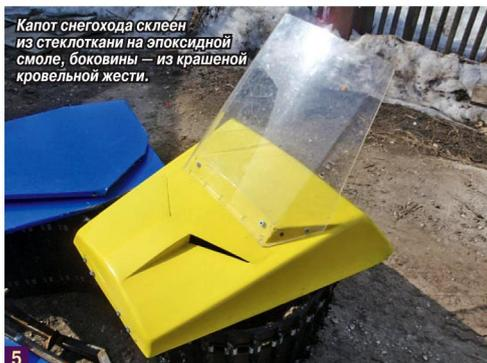
Капот снегохода склеен из стеклоткани на эпоксидной смоле, боковины — из крашеной кровельной жести.
