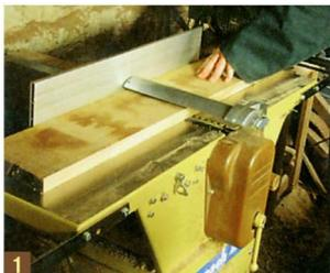
1 Прострогаем доски шириной 156 мм до толщины 22 мм, отпилим их в размер.
