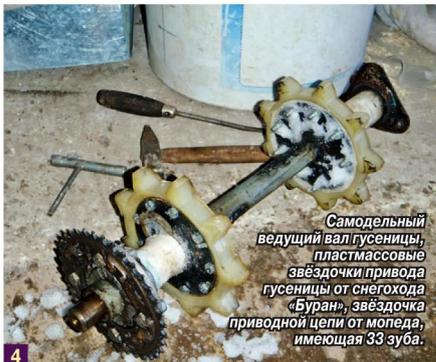
Самодельный ведущий вал гусеницы, пластиковые звёздочки привода гусеницы от снегохода «Буран», звёздочка приводной цепи от мопеда, имеющая 33 зуба.
