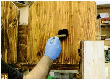
**26** В качестве защитного покрытия для дивана подойдут любые лазури и мастики, стойкие к осадкам и ультрафиолетовому воздействию. Только нужно помнить, что впитывающиеся составы надо периодически обновлять. Покрывные мастики менее стойки к атмосферным воздействиям, но обновлять их достаточно просто.
