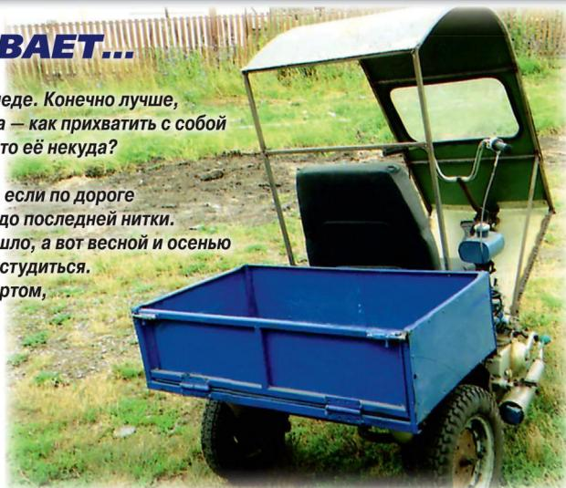
**Задний борт кузова легко откидывается вниз. Снять его полностью — не намного сложнее.**
